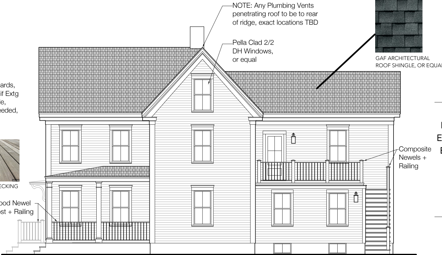
2 Side Exterior Elevation SCALE: 1/8" = 1'-0"
